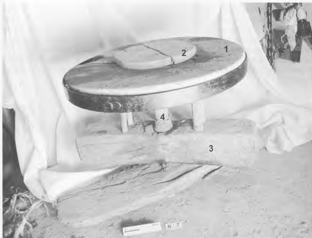
Figura 2. Torno alfarero de Zarzuela de Jadraque con indicación de sus partes: 1 rueda, 2 rodal central, 3 corredera y 4 estaca. Torno propiedad de Basilio Sanz Martín.
